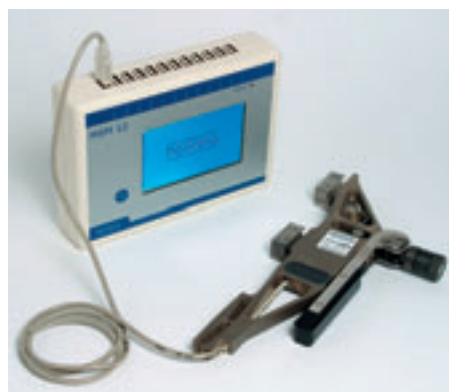
Abb. 2: Mobiles Seillastmessgerät MSM12 und ein Seillastsensor LSM1 aus dem Messsystem WeightWatcher
