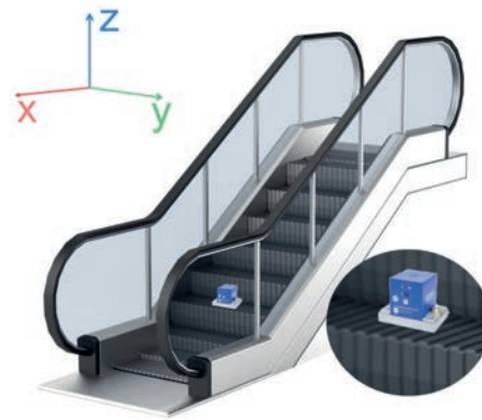
Ausrichtung und Positionierung des Vibrationssensors auf der Fahrtrepppe
