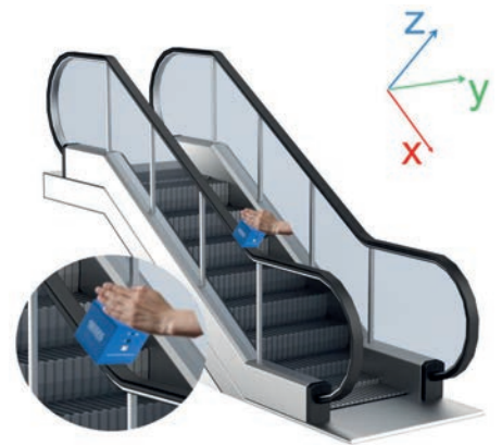
Ausrichtung und Positionierung des Vibrationssensors auf den Handläufen
