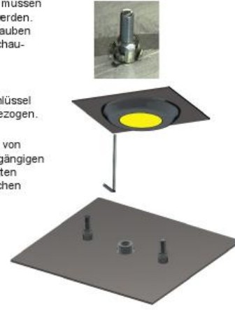
3. Anbaumöglichkeit bei keinem Ausschnitt. Es müssen drei Löcher gebohrt werden. 2 x Ø 7mm für die Einsteckmuttern, Lochab- stand 59 mm und ein mittiges Loch Ø 12 mm für die Kabeldurchführung
