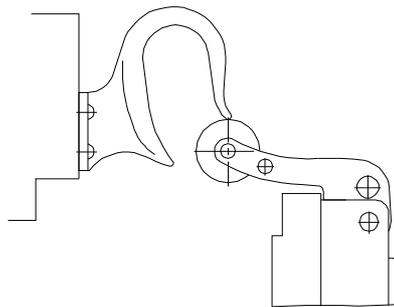
Um ein optimales Schließverhalten zu gewährleisten, ist es erforderlich die Anbauhöhe genau einzustellen, sowie den Versatz der unterschiedlichen Türarten durch Unterlegen des Schließers bzw. der Einlaufkurve auszugleichen.
